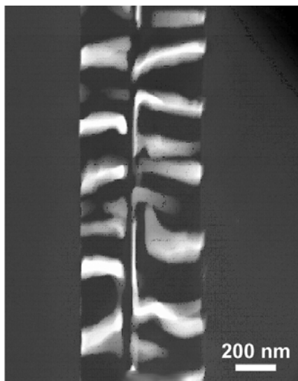
Рис.2. Электронно-микроскопическое изображение ламели в темнопольном режиме. Черные и белые полосы – диопсид и хромит соответственно
