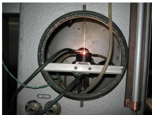
Фото 2. Горелка плазматрона: фото (справа) и схема (слева).
