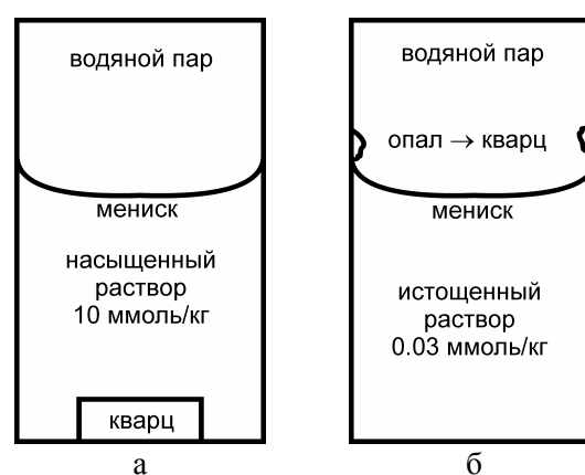
Рис. 1. Схематичное изображение состояния системы кварц-вода в ампулах: а — равновесное состояние (<100 сут), б — неравновесное состояние (>600 сут).
