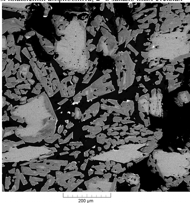
Рис. 2. Амфиболы после опыта S-1. Центральная светлая – железистая часть минерала, краевая темная – магниальная
