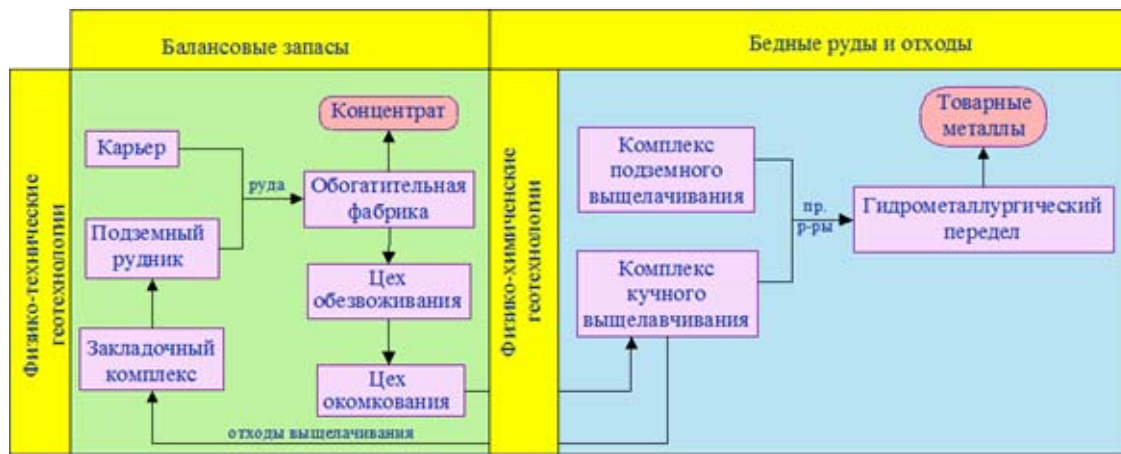
Рис. 6. Организационно-производственная структура горно-перерабатывающего предприятия при комплексном освоении рудных месторождений с вовлечением в эксплуатацию техногенного сырья.
