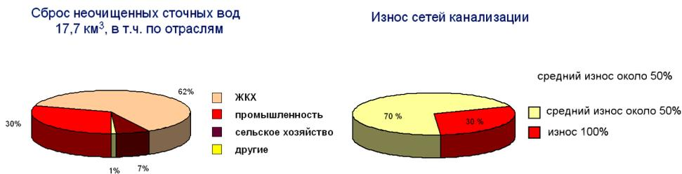
Рис. 8. Значительная часть сброса неочищенных сточных вод и потерь воды происходит в системе ЖКХ.
