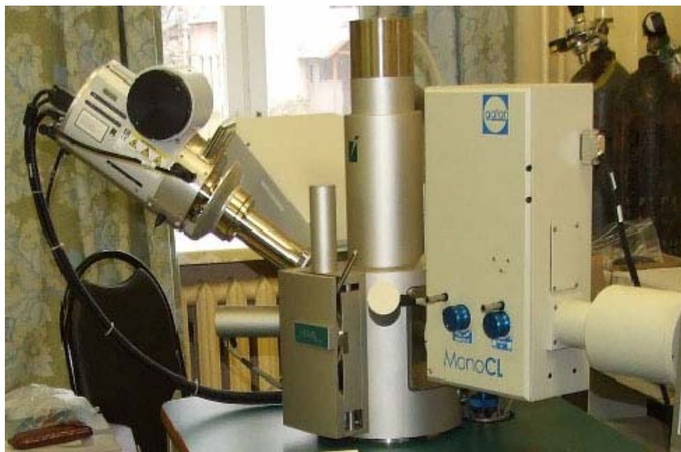
Рис. 4. Катодолюминесцентный детектор MonoCL3 с новым Пельтье охлаждением HSPMT с интегрированным предварительным усилителем, с низкой базовой температурой, с интеллектуальным блоком питания (ГО «Борюк»).
