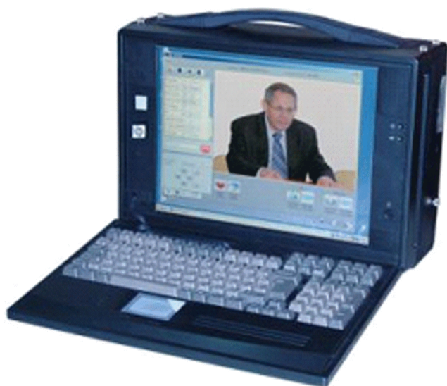
Рис. 6. Мобильный мультисервисный защищенный абонентский пункт на основе аппаратно-программного модуля видеоконференцсвязи “Ирга” (ООО “Стэл КС”).
