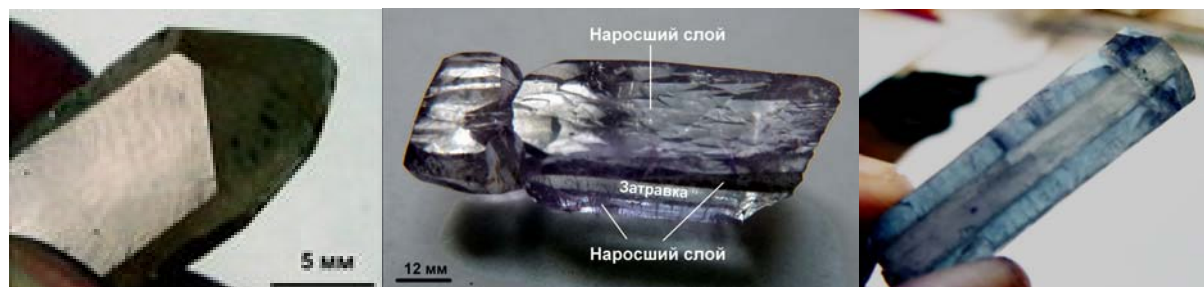
Рис. 1. Внешняя морфология монокристаллов Cr-содержащего синтетического топаза
