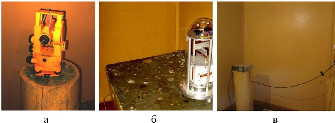
**Аппаратура для магнитных наблюдений: а – деклинометр/инклинометр;
